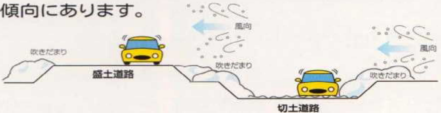
盛土道路と切土道路での吹きだまりの様子
